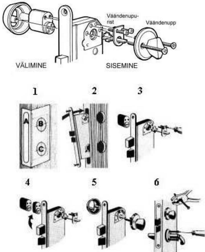
Enne luku paigaldamist kontrollige, kas uks töötab korrektelt. Kui soovite uksele panna tihendid, tuleb seda teha enne lukupaigaldust. Hilisem ukse tihendamine nõub luku vasturaua asendi muutmist või koguni ümbervahetamist.
